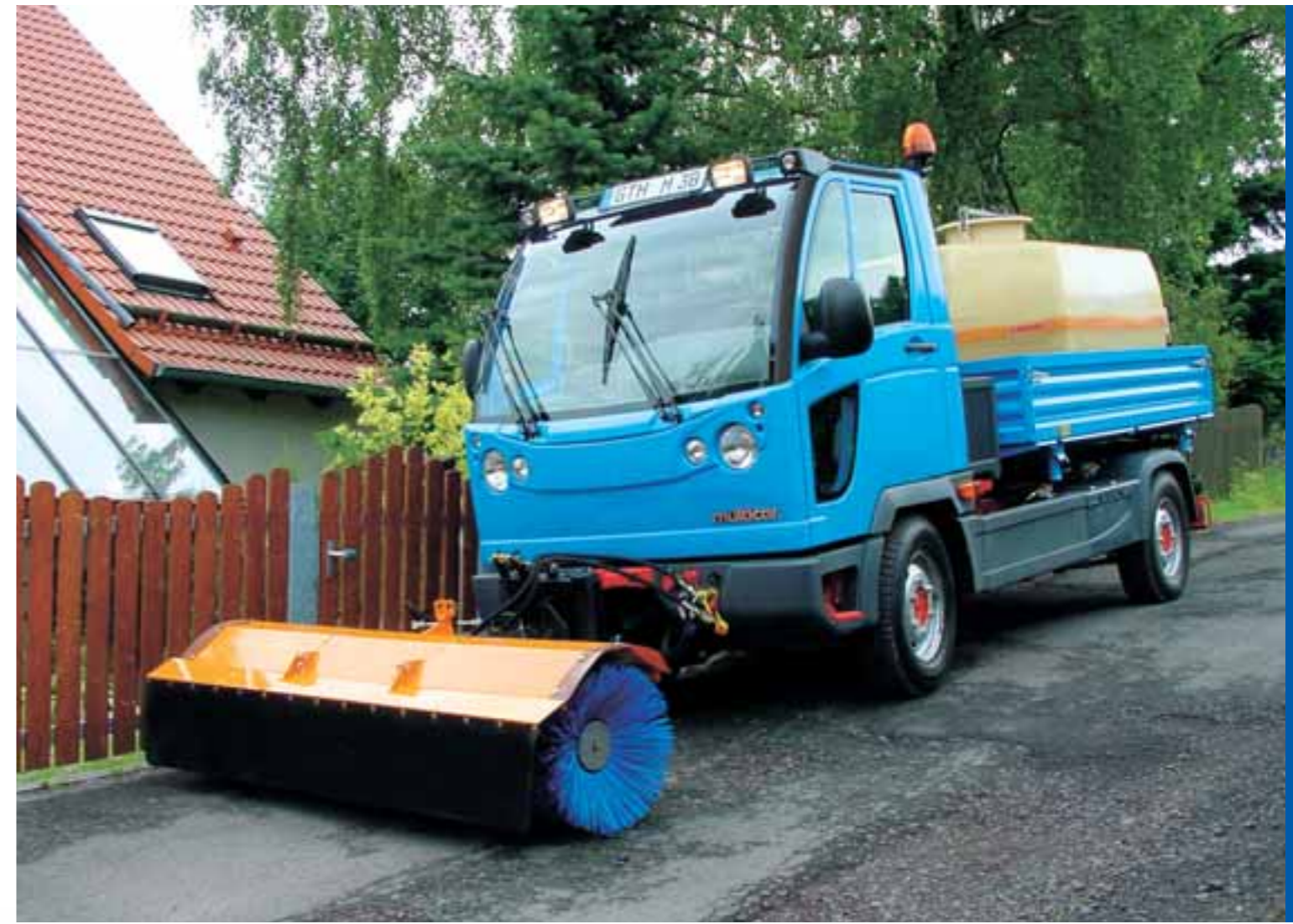
FUMO beseitigt dank 3-Kreis-Hydraulik mit Kehrwalze und Wasserfass die letzten Spuren.
