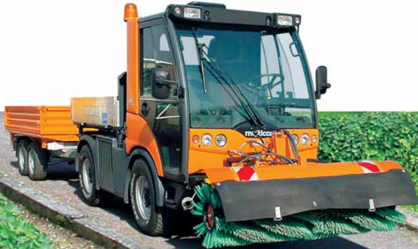
Mit Edelstahlsprühbalken und Wassertank reinigt der TREMO Carrier Straßen und Plätze.
