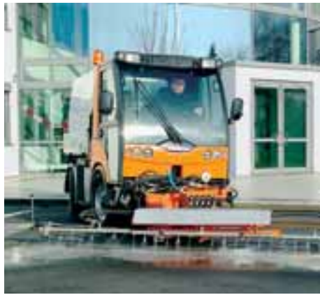
Mit Edelstahlsprühbalken und Wassertank reinigt der TREMO Carrier Straßen und Plätze.
