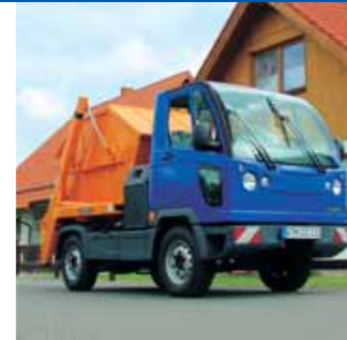
FUMO mit teleskopierbarem Absetzkipper und einem Ladevolumen bis zu 2,5 m 3 .
