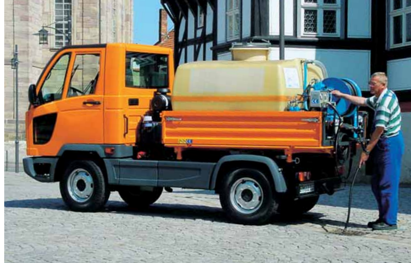
Mit 140 bar Wasserdruck spült FUMO Schmutz und Verstopfungen aus dem Kanal.
