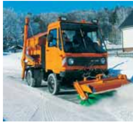
Auch mit Kombistreuer auf dem Absetzkippaufbau und einer Vorbaukehrmaschine meistert der M 26 den Wintereinsatz.
