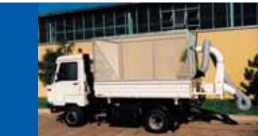
Bis zu 6,6 m 3 Laub saugt der M 26 mit langem Radstand in seinen Gitteraufsatz.
