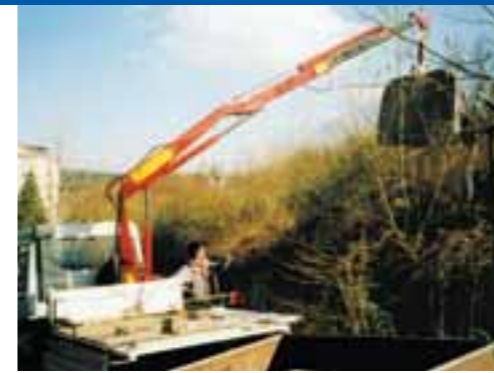
Dank robuster Bauweise, Hydraulik und Kran trägt der M 26 Lasten mühelos über 11 m Entfernung.
