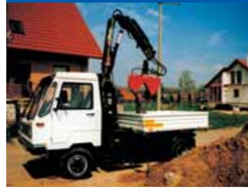
Selbst beladen und abtransportieren aus engen Baustellen mit dem M 26.
