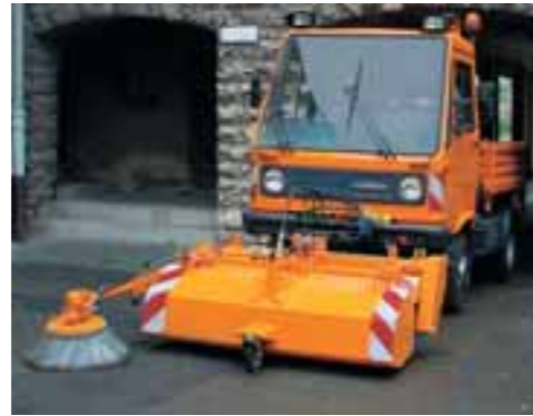
Innerhalb weniger Minuten vom Baufahrzeug zur Kehrmaschine umgerüstet: der M 26.
