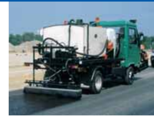
Für langfristige Verbindungen: M 26 mit Spritzmaschine für 2.000 l Straßenbau-Bindemittel.
