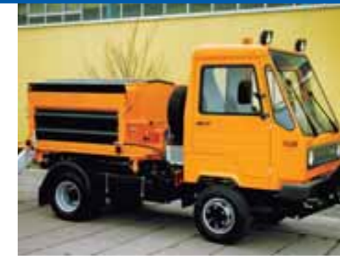
Straßenbau mit dem M 26 plus Asphalt-Thermo-Container.
