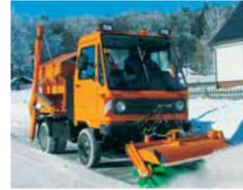
Mit einer Fahrgestell-Tragfähigkeit von bis zu 3 t schultert der M 26 kraftvoll Kombistreuer und Vorbaukehrmaschine.
