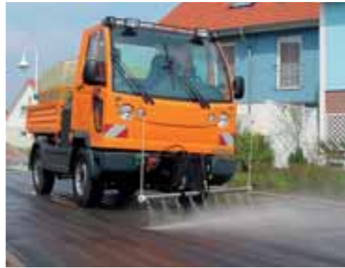
Mit Edelstahlprühbalken, Wassertank und 140 bar Druck reinigt FUMO die Straßen von Bauverschmutzungen.
